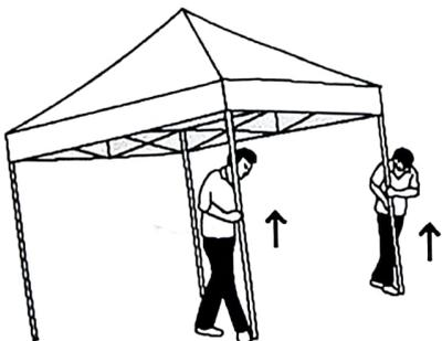
**2** Libere el control deslizante en cada esquina presionando el botón para liberar la presión y así poder desmontarlo. Repita en los cuatro lados.
