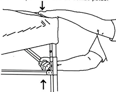
**4** Levante las dos patas exteriores hacia arriba y saque las patas internas hasta que pueda poner el seguro. Repetir en todas las patas. Levante o nivele la carpa usando los orificios de ajuste que se encuentran cerca de la parte inferior de cada pata exterior.
