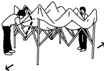
**3** Enganche el control deslizante en cada esquina empujando hacia arriba con una mano mientras mantiene presionada la parte superior de la pata con la otra mano. El botón de presión se enganchará en la ranura. Repetir en todas las demás patas.
